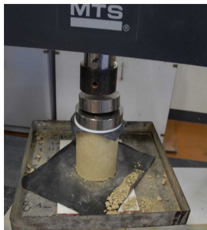
Photo 1 : Dispositifs de réalisation des essais de compression simple
