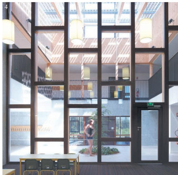
1 -Le principe de structure poteaux-poutres autorise, en façade comme à l'intérieur, des parois largement vitrées pour optimiser la lumière naturelle et créer des échappées visuelles.
