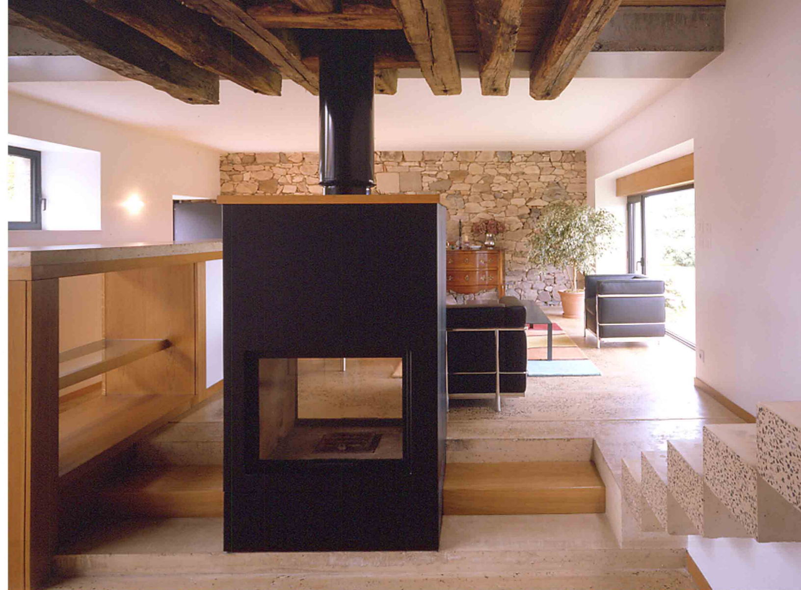
La cheminée, ouverte à la fois sur le séjour et la cuisine, possède un insert double ouverture de marque Chaverneau dissimulé par un habillage en tôle noire cirée. Le plancher chauffant a joué bien des surprises pendant le chantier : « on n'arrivait plus à poncer le béton blanc » raconte l'architecte. Il a été grenaillé, poncé et poli avec une finition à l'huile d'Oxane.
